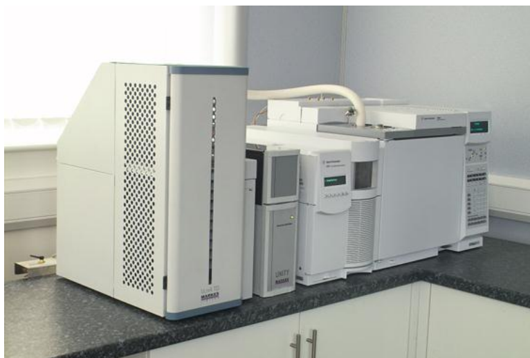
Figur 9.8– Termisk desorpsjonsenhet med GC/MS
